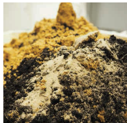
Filterjordens egenskaber afhænger bl.a. af jordens tekstur, dvs. fordelingen mellem sand, silt, ler og organisk materiale.
